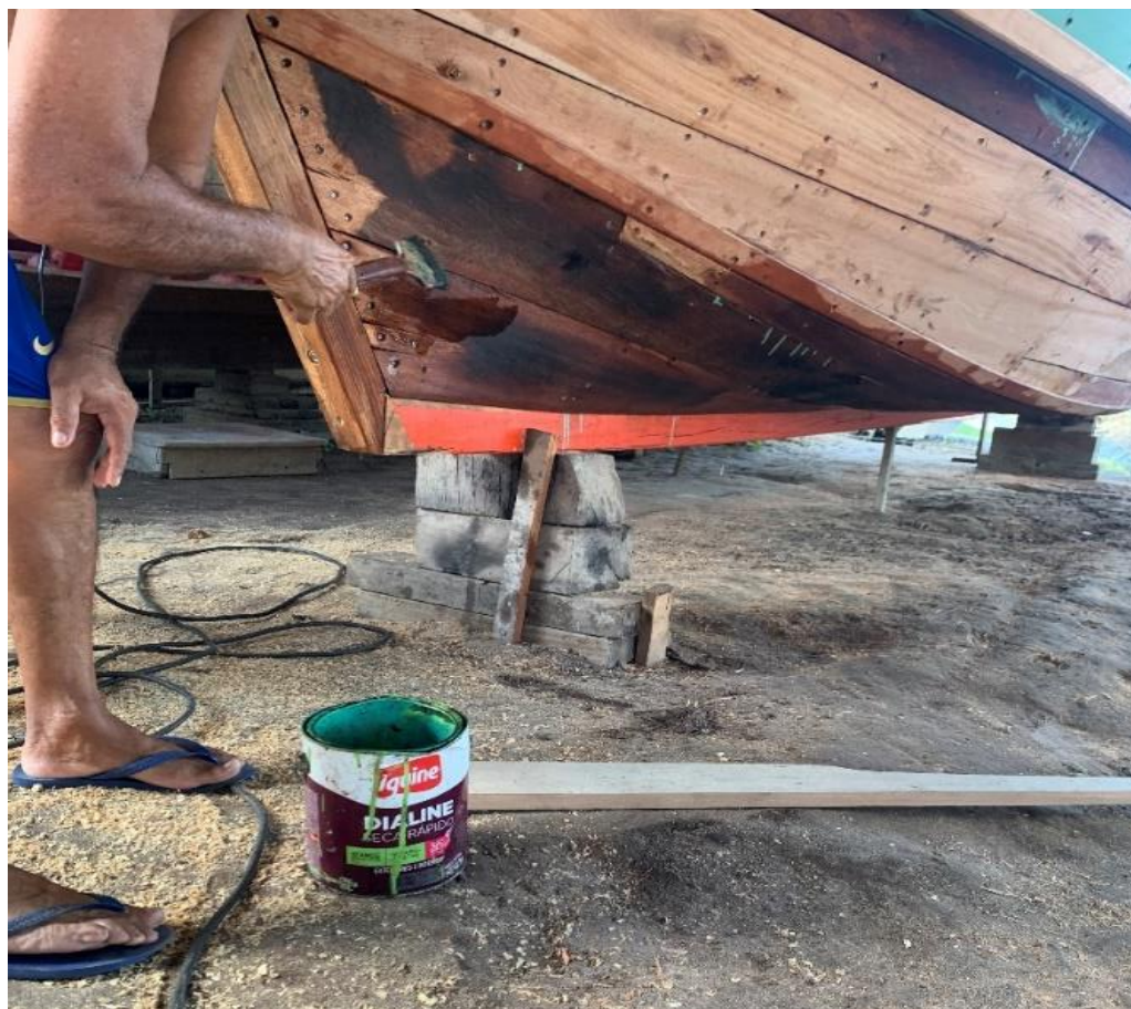
Figura 7 - Imagem do óleo queimado aplicado no processo de envenenamento da madeira das embarcações. Fonte: elaborado pela autora.
